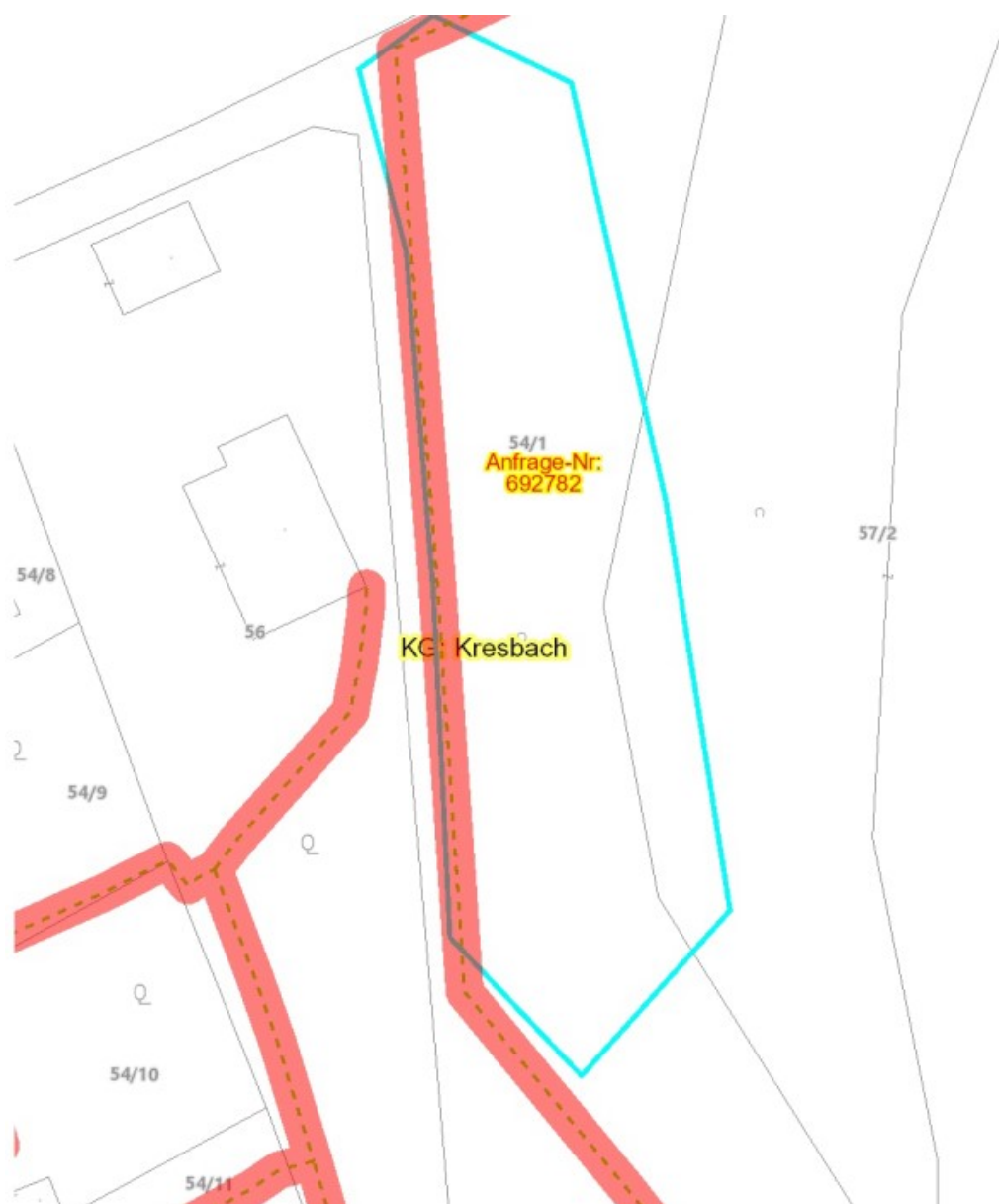
Auszug Leitungsauskunft Strom – Energie Stmk.
